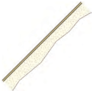
ESPACE DE CHEVRON REMPLE AVEC DE LA MOUSSE GICLÉE
