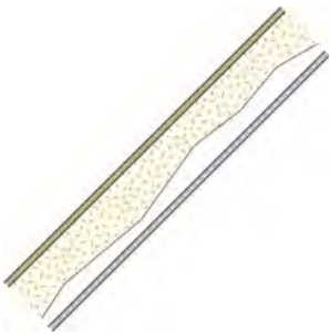
CAVITÉ REEMPLIE AVEC DE LA MOUSSE GICLÉE
